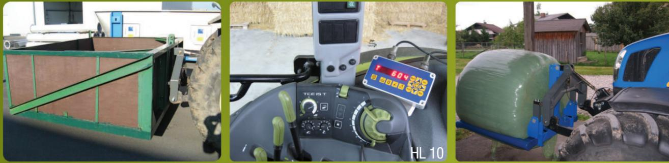
Das Wiegendreieck WD 2.1 wurde entwickelt um das Wiegen von Dreipunktgeräten an Schleppern an der Front- und Heckhydraulik zu ermöglichen.
